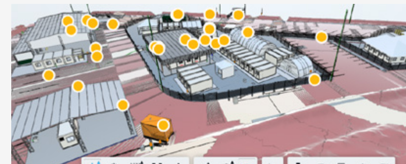
Visualização das restrições identificadas em cada local por meio do BIM360
